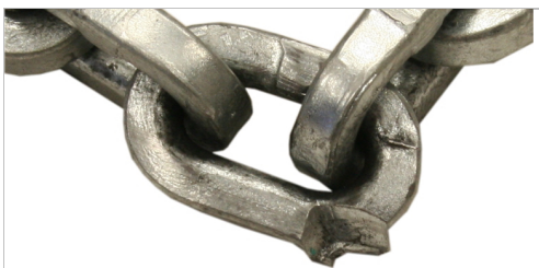
Mechaniczne uszkodzenie ogniwa łańcucha.
