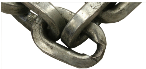
Duży stopień zużycia ogniwa łańcucha.
